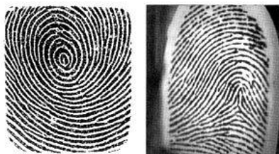
图5 FPS200采集的指纹图像 图6 光学采集指纹图像 http://www.gg-gddq.com
